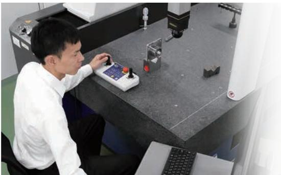
国内3拠点、海外1拠点ある品質管理センターには、CNC三次元測定機や画像寸法測定器などデジタル計測機器を複数保有し、高度な技術を持つ25名以上の検査員が丁寧に部品の検査を行います。
